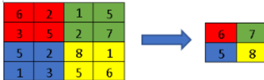
Figure-4. Max pooling [19].
