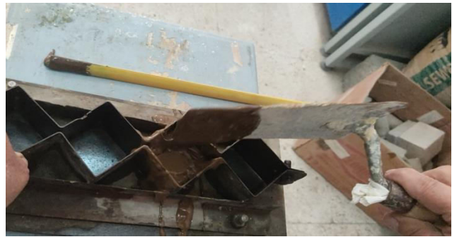
Figure-5. Pouring NLGP inside 50x50x50 mm cubes.
